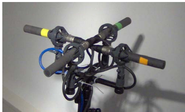
Abbildung 4-9 : IRT-Kreuz mit vier Schoeps MK-4 Mikrofonen
